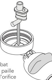
Con la tapa a presión abierta, inserte la parte superior del popote en el orificio hasta que su base esté completamente apoyada en la parte inferior de la tapa.
