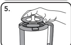
**5.** Coloque el anillo adaptador encima de la canasta removible. Si el anillo adaptador no encaja holgadamente alrededor del biberón o no se apoya bien sobre la canasta removible, no lo use. Enchufe la unidad en el tomacorriente de pared.
